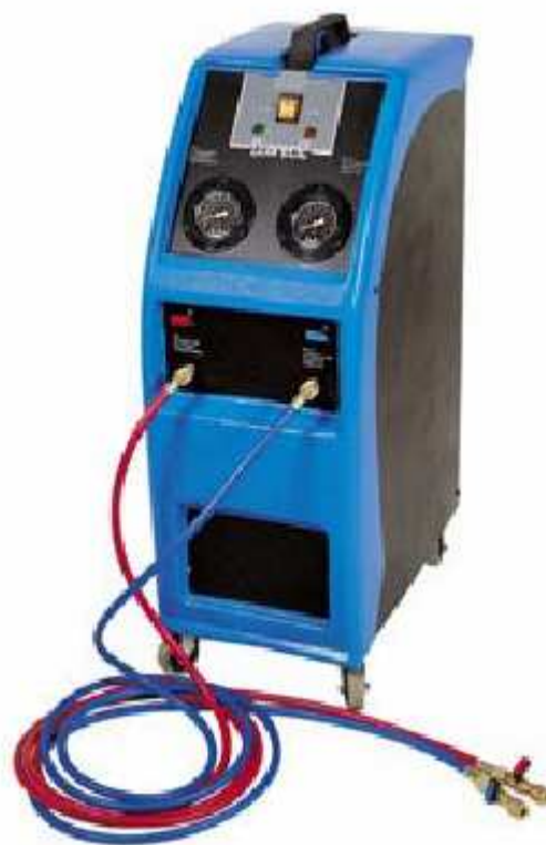
Rys. 4. Urządzenie do usuwania czynnika chłodniczego z samochodowych układów klimatyzacyjnych – źródło PIAP*
