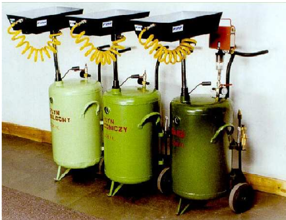
Rys. 2. Widok ogólny zestawu do usuwania płynów eksploatacyjnych – źródło PIAP*
