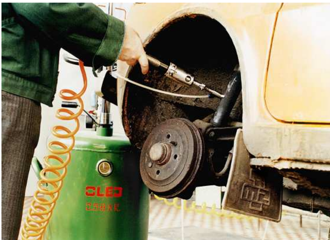
Rys. 5. Specjalistyczne urządzenie do usuwania oleju i gazu z amortyzatorów i sprężyn gazowych – źródło PIAP*
