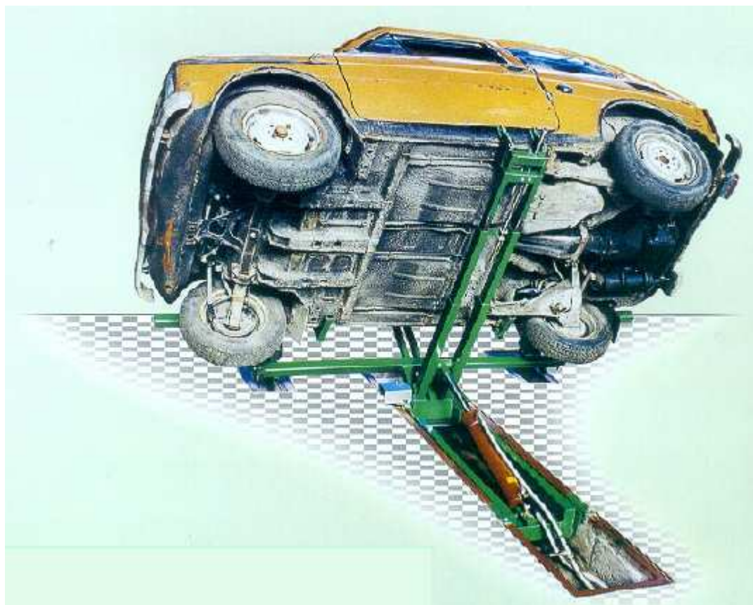
Rys. 7. Hydrauliczna obrotnica samochodów – źródło PIAP*
