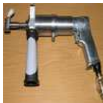
Rys. 8. Urządzenie do usuwania oleju i sprężonego gazu z amortyzatorów i sprężyn gazowych samochodowych – źródło PIAP*
