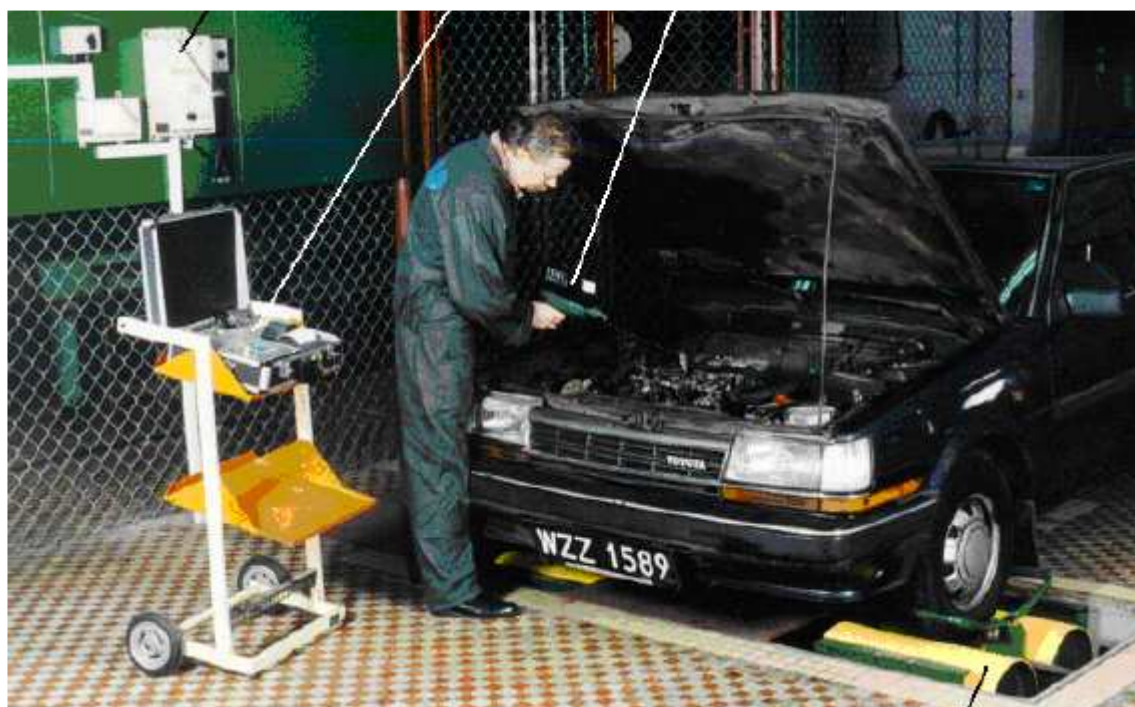
Rys. 1. Testowanie silnika na stanowisku wyposażonym w rolki napędowe – źródło PIAP*
